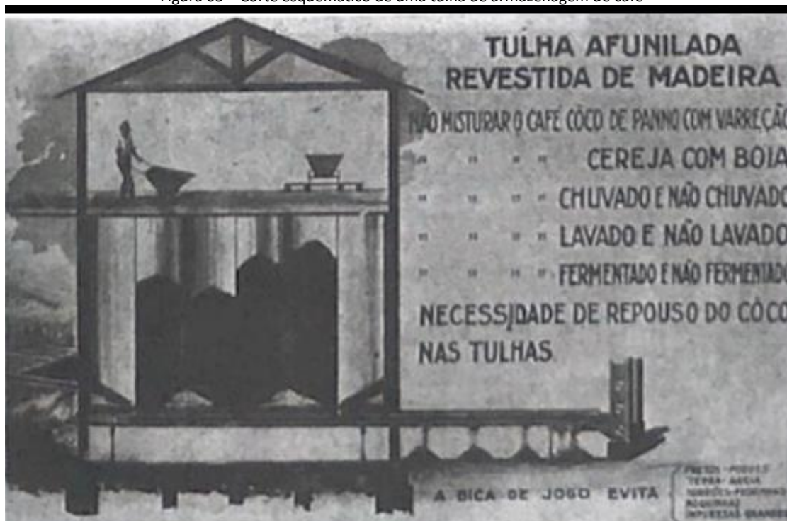
Figura 05 – Corte esquemático de uma tulha de armazenagem de café
