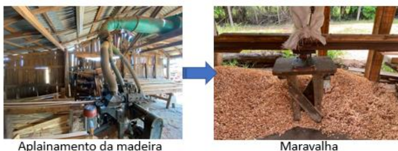
Figura 4 – Processo de beneficiamento da tora de madeira
