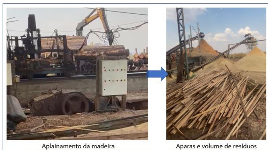
Figura 5 – Processo de beneficiamento da tora de madeira
