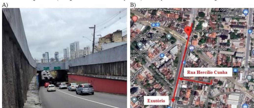
O Túnel da Abolição, Figura 4A, apresenta uma cota muito inferior, quando comparada ao nível das ruas adjacentes, Figura 4B. O traçado em destaque representa o coletor tronco principal, que possui 600 mm de diâmetro e que se inicia na Rua Real da Torre e segue até o seu exutório no canal existente na Rua João Ivo da Silva, recebendo a contribuição da rede coletora proveniente da Rua Hercílio Cunha.
