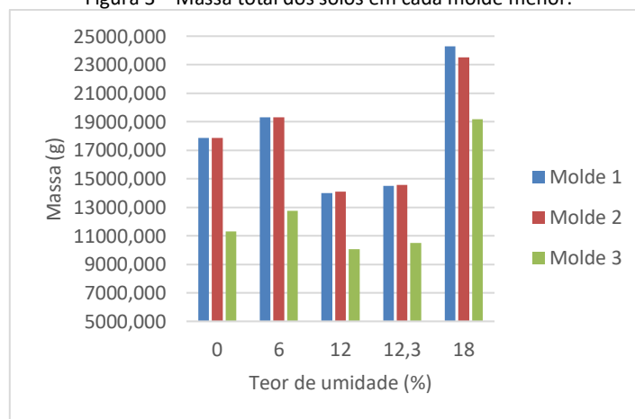
Figura 3 – Massa total dos solos em cada molde menor.
