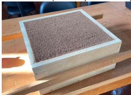
Figura 2 – Molde 1 em ensaio para obtenção da massa específica solta.
