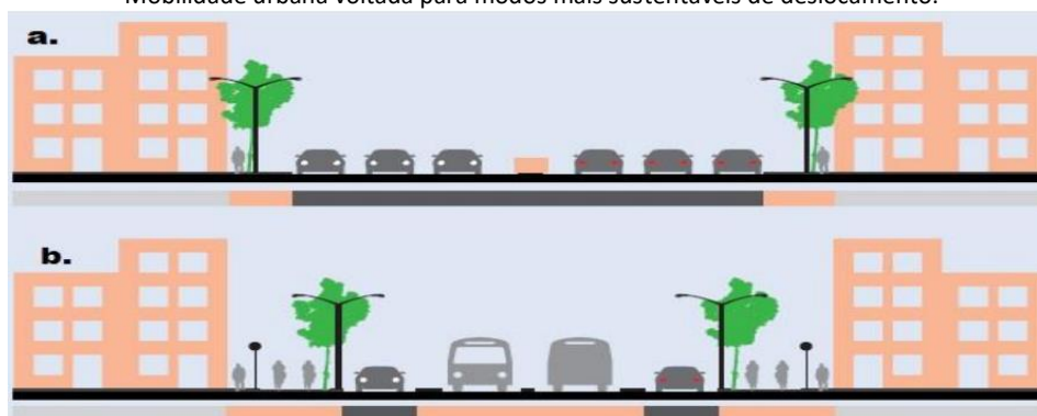
Figura 2 - a. Ênfase na mobilidade urbana voltada para modos motorizados e individuais de deslocamento. b. Mobilidade urbana voltada para modos mais sustentáveis de deslocamento.
