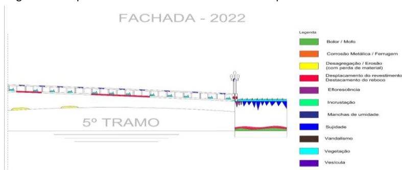
Figura 22: Mapa de danos da fachada do tramo 05 da ponte Santa Isabel - 2022.
