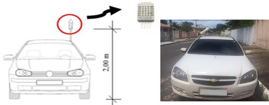
As aferições iniciavam sempre às 20 horas com velocidade do veículo variando entre 30 e 40 km/h, em dias com condições climáticas estáveis, com ventos leves e céu claro (OKE, 2004; VALIN Jr., 2019) passando por 19 pontos na cidade, sendo o transecto Leste-Oeste (L-O) com 10 pontos (19,76km) e o transecto Sul-Norte (S-N) com 9 pontos (11,6km), durante as estações do verão e o inverno de 2016 (Figura 3).
