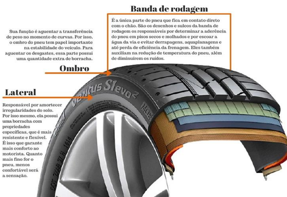
Figura 2 – Descrição das partes do pneu
