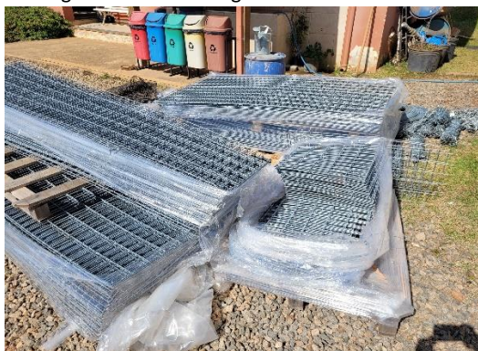
Figura 7 – Painéis do gabiões eletrosoldados
