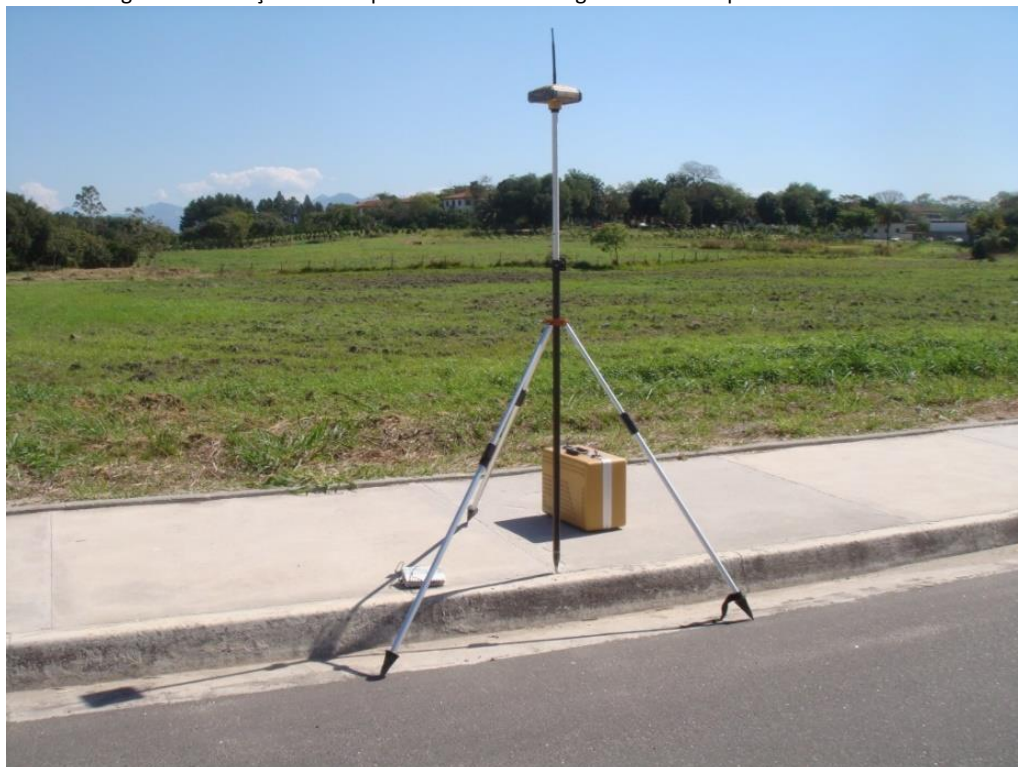
Figura 4 – Medição em campo das Coordenadas geodésicas dos pontos de controle
