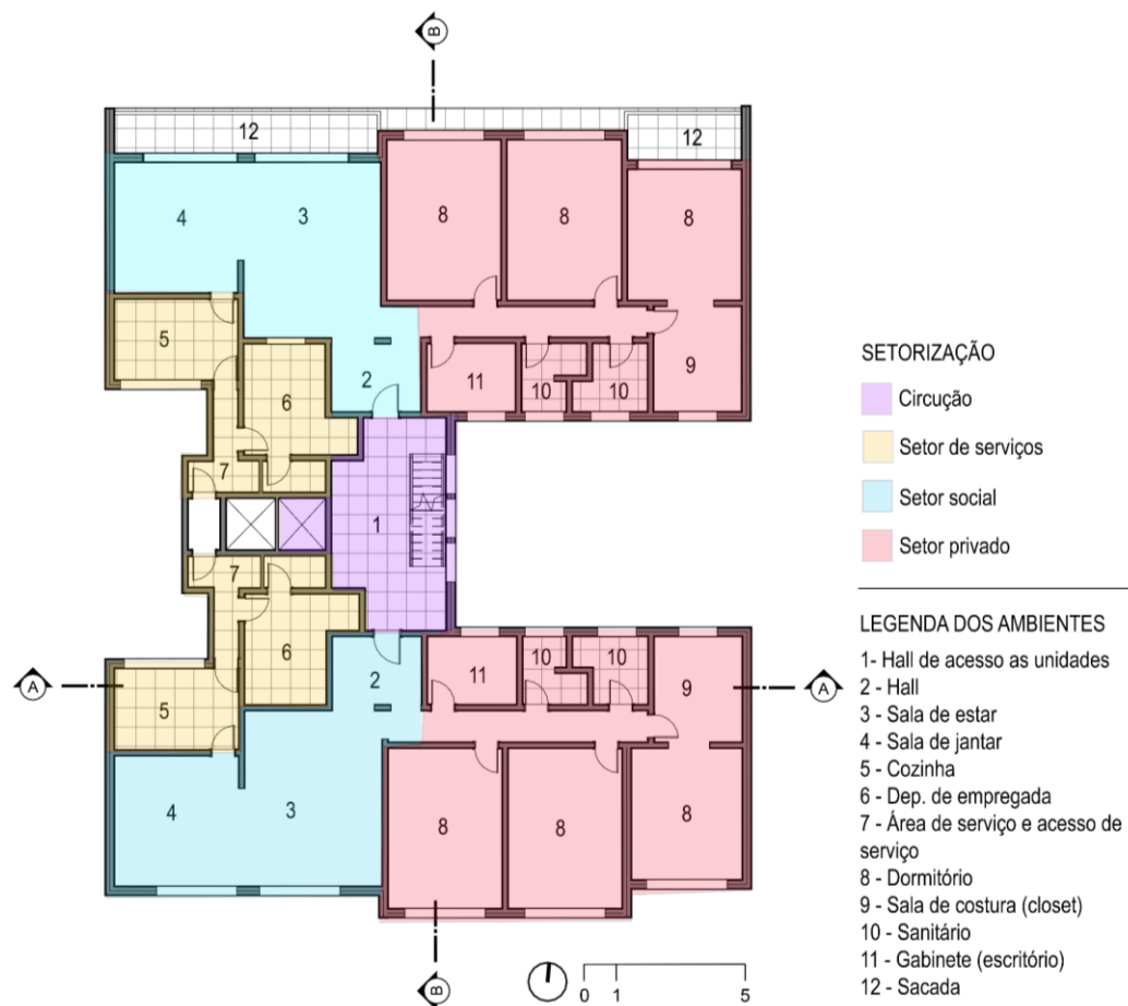
Figura 3 - Planta baixa Edifício Linck, pavimento tipo.
