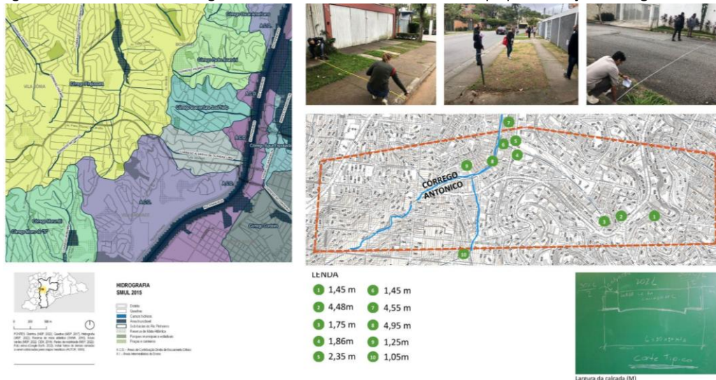
Figura 2 – Divisão bacias hidrográficas da área e levantamento de campo para aferição de larguras de rua
