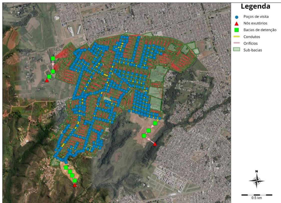
Figura 2 - modelagem da rede de drenagem no modelo.
