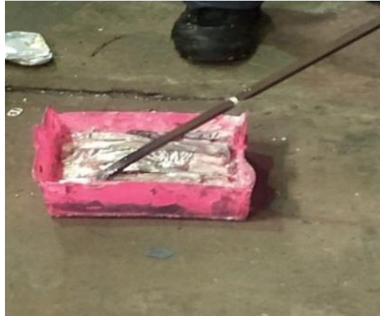
Figura 5: Cadinho com alumínio fundido e formação de escória na superfície.
