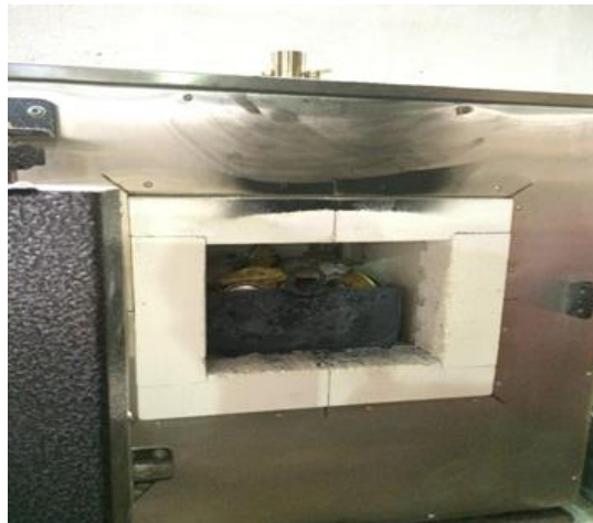
Figura 4: Posicionamento do cadinho com as latas de bebidas no interior do forno para fundição.
