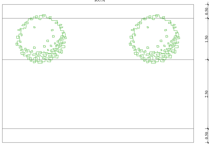
Figura 1: Calçada com 3 metros de largura. RUA
