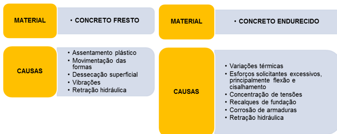
Figura 2 – Causa de fissura em relação ao material.
