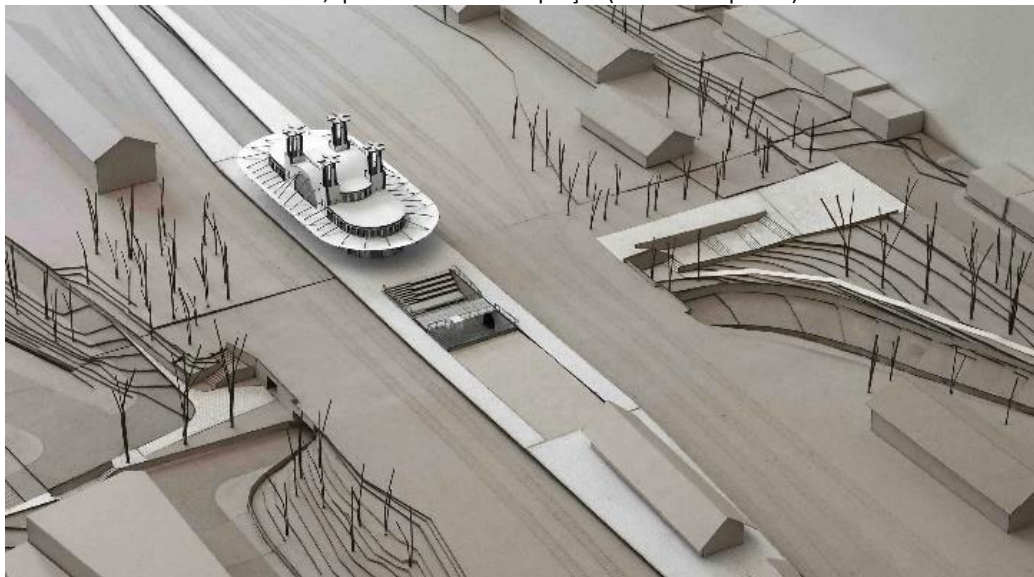
Figura 12 – Maquete eletrônica do projeto para a Estação de Mairinque onde se vê o acesso por escadas ao centro do túnel, que conecta as duas praças (direita e esquerda).
