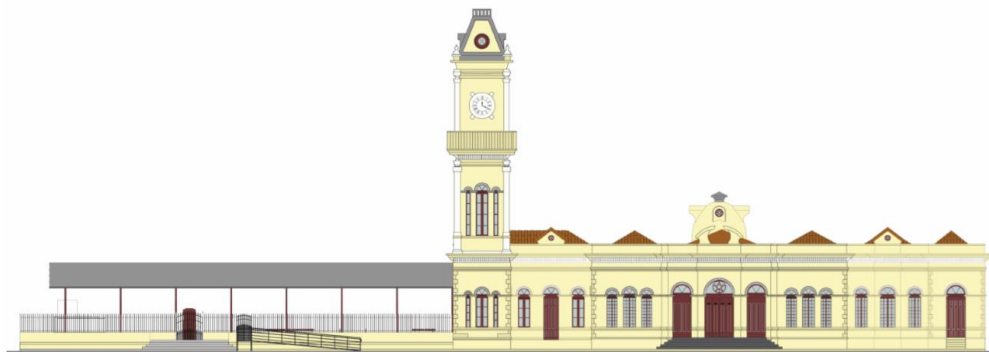
Figura 17: Levantamento geométrico - fachada Frontal.
