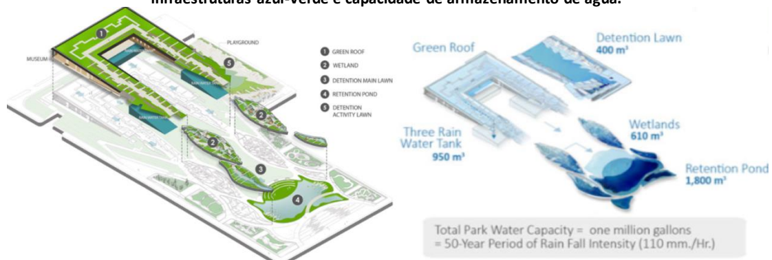
Figura 1 - Projeto do Parque Centenário da Universidade Chulalongkorn, destacando seu conjunto de infraestruturas azul-verde e capacidade de armazenamento de água.
