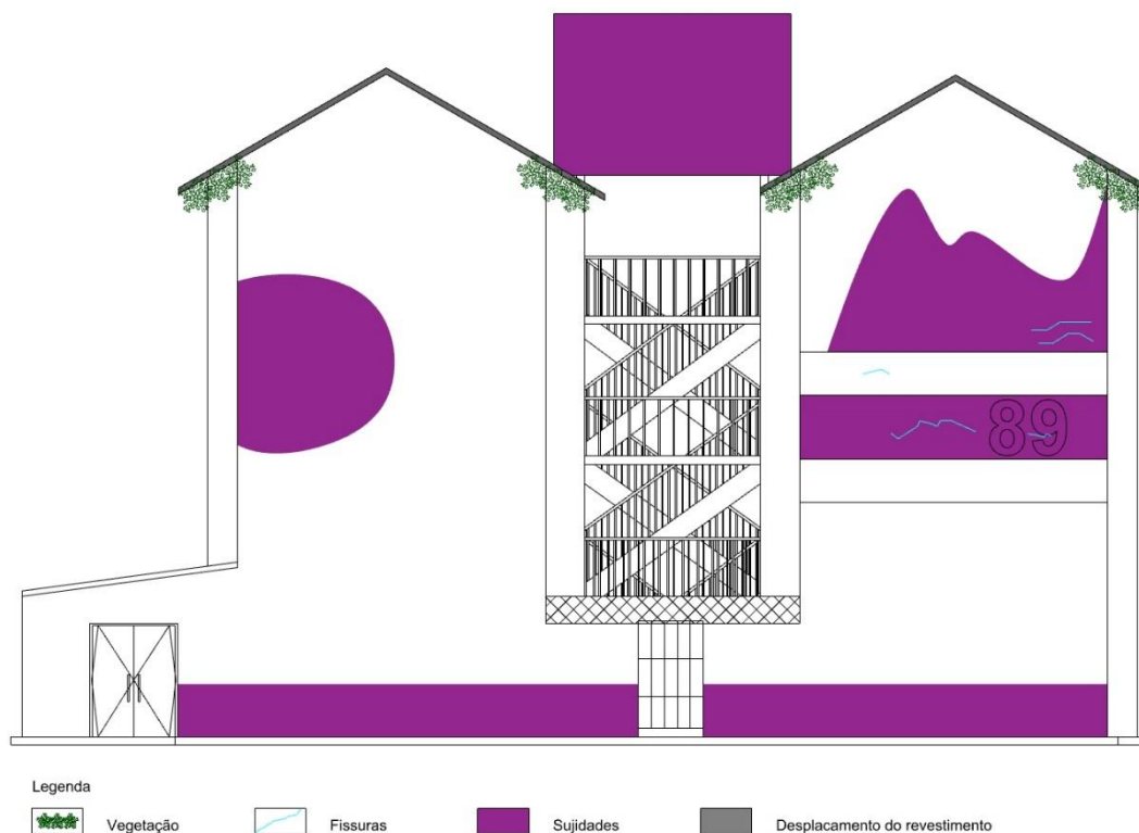
Figura 3 – Mapa de danos da fachada oeste do Bloco 89
