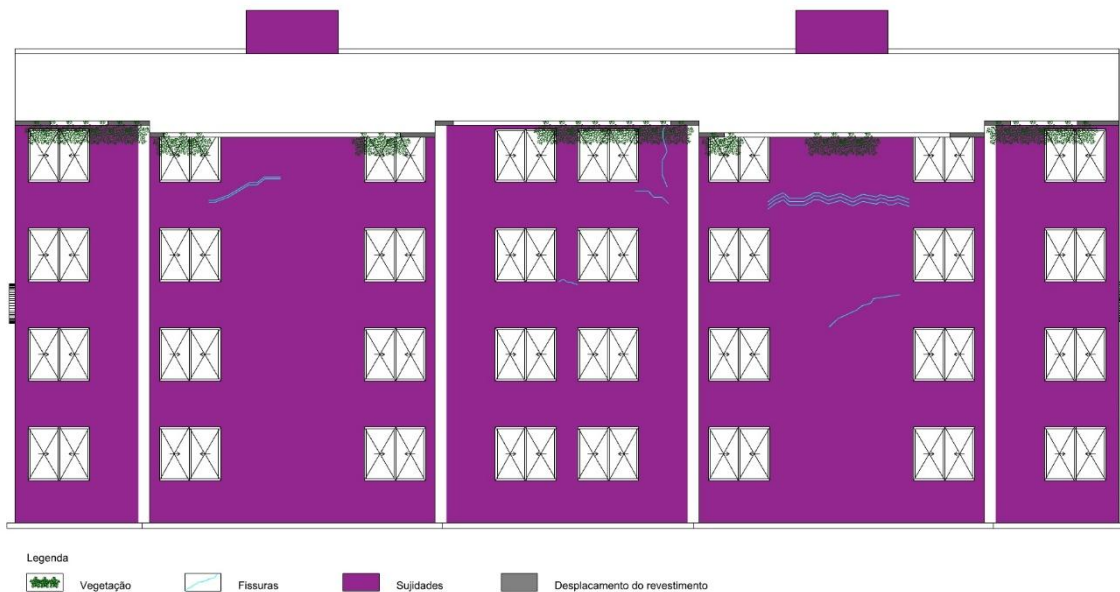
Figura 7 – Mapa de danos da fachada sul do Bloco 89
