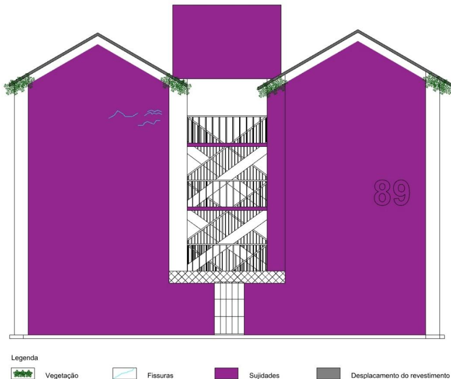
Figura 5 – Mapa de danos da fachada leste do Bloco 89
