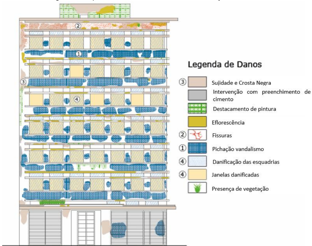
Figura 10: Mapas de Danos na fachada norte da edificação SulAmérica
