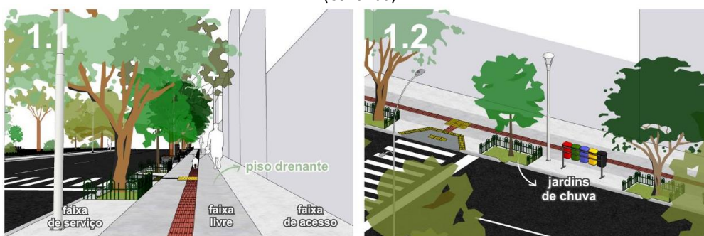
Figura 15 – Representação ilustrativa das diretrizes gerais: (1) Requalificação das calçadas; (2) Reorganização dos canteiros viários; (3) Requalificação das paradas de ônibus; (4) Implementação da iluminação pública pedonal; (5) Elaboração de um plano de manejo para as espécies exóticas; (6) Reorganização dos canteiros nas calçadas.
