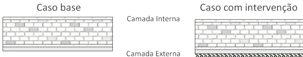
Figura 2 – Representação da alvenaria no caso base à esquerda e com intervenção à direita.
