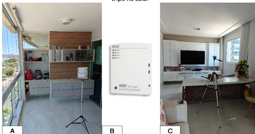
Figura 4 – a) Conjunto (Hobo + abrigo) da varanda; b) Data logger HOBO, modelo U12-013; c) Hobo em tripé na sala.
