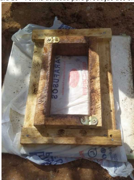
Figura 10 – Forma utilizada para produção dos blocos
