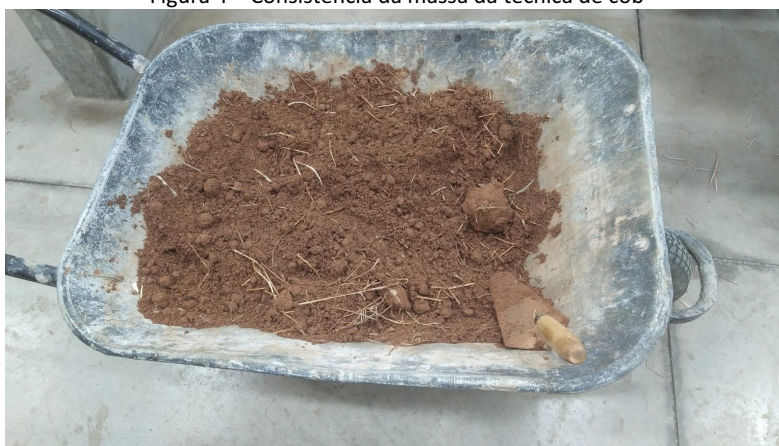
Figura 4 – Consistência da massa da técnica de cob
