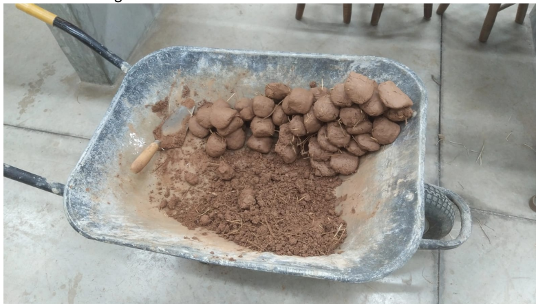
Figura 5 – Consistência da massa da técnica de cob
