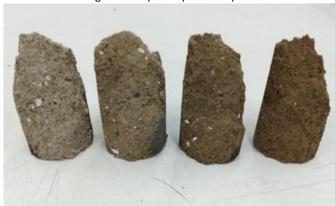
Figura 2. Corpos de prova rompidos
