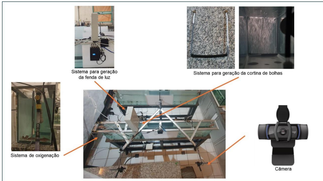
Figura 1 – Detalhes dos acessórios e componentes do aquário instrumentalizado utilizado nos ensaios para avaliação do comportamento da ictiofauna em resposta à cortina de bolhas associada à luz permanente.
