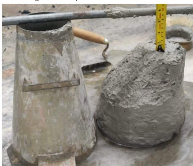
Figura 6 - Slump test com 50% de escória.
