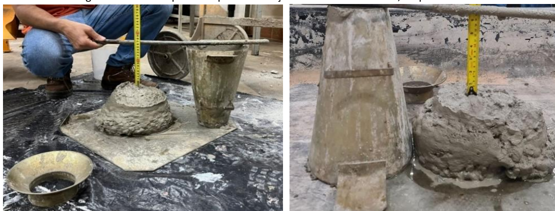
Figura 4 e 5 – Slump test do primeiro traço e com 20% de escória, respectivamente
