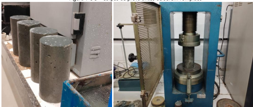
Figura 7 e 8 – Corpos de prova antes de serem rompidos
