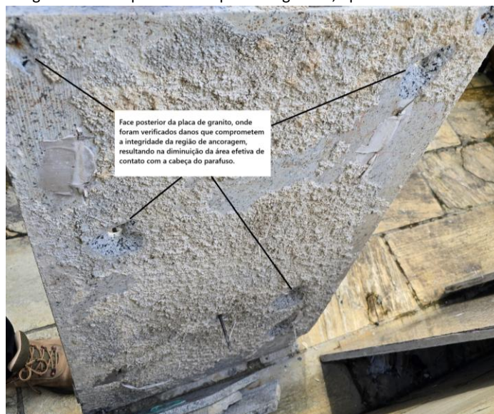
Figura 9 – Face posterior da placa de granito, apresentando danos.
