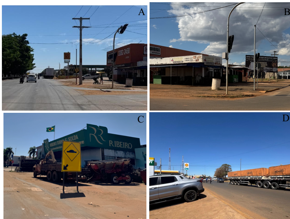
Figura 10- (a) e (b) Calçada sem pavimentação e acessibilidade (c) Obstáculos na calçada (d) Uso da calçada como estacionamento
