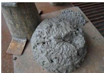
Figura 4 – Análise visual da consistência dos concretos
