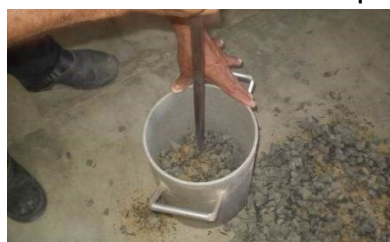
Figura 2 - Ensaio de massa unitária compactada
