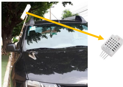
Figura 04 – Adaptação do sensor para transecto móvel
