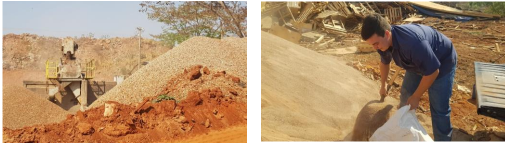
Figura 1: Imagem a esquerda de processamento de material de reciclagem da empresa Mejan Ambiental e a direita, coleta da areia reciclada - RCD-R, Votuporanga/SP, 2020.
