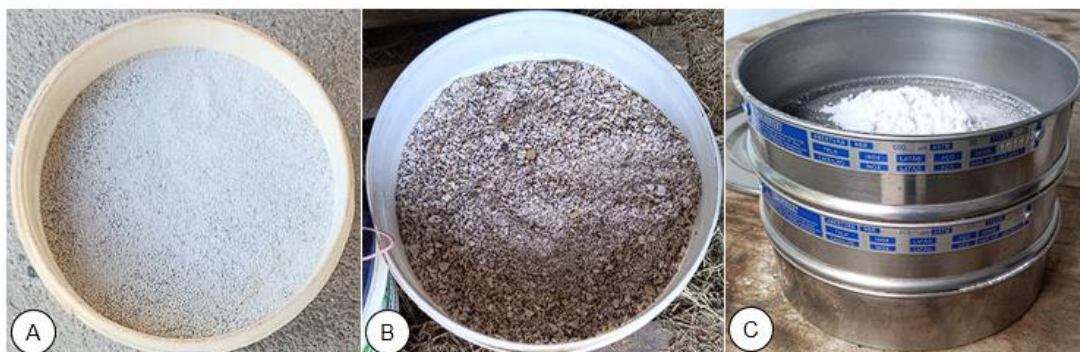
Figura 2 – Trituração, moagem e peneiramento das conchas
