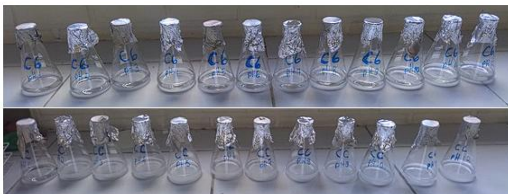
Figura 3 – Ensaio para determinação do pH pcz
