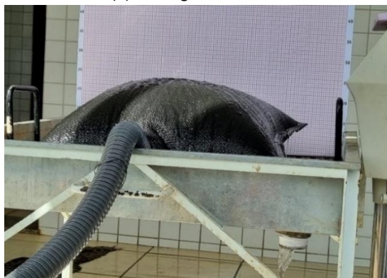
(d) Bolsa geotêxtil no processo de desaguamento
