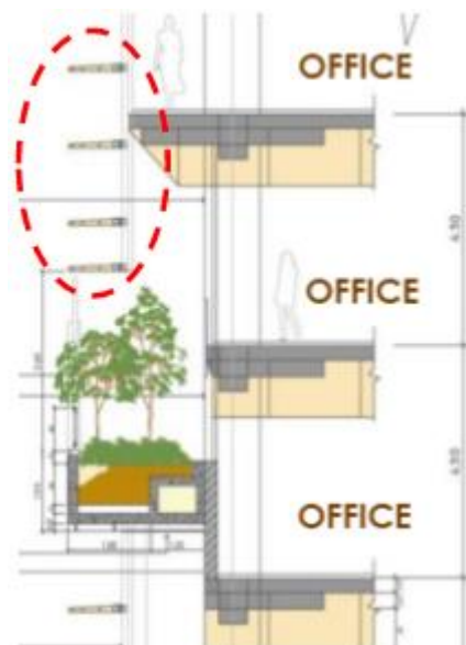
Figura 9 – Corte esquemático e indicação de localização dos brises horizontais presentes no projeto para o controle de incidência solar.
