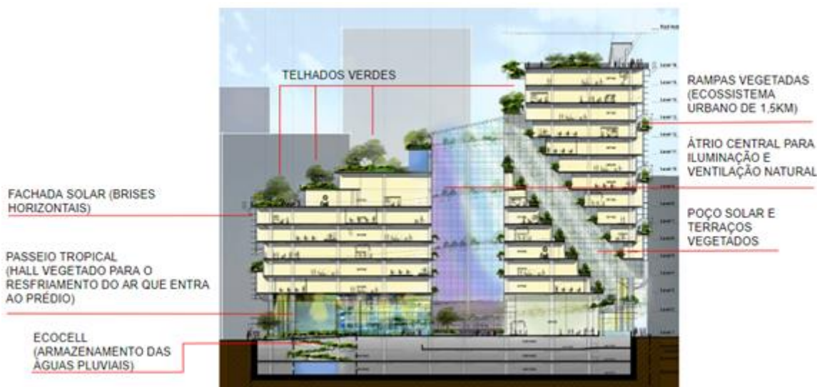
Figura 5 - Corte esquemático indicando as principais estratégias bioclimáticas utilizadas pelo arquiteto Ken Yeang.
