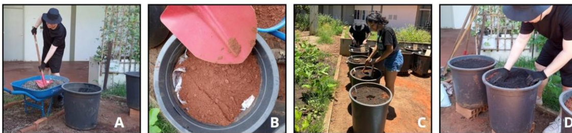
Figura 4 - Montagem do experimento. A - Inserção da camada de brita basáltica. B - Adição de solo de cerrado sobre a manta bidim. C - Semeadura das espécies. D - Aplicação de camada de terra vegetal.
