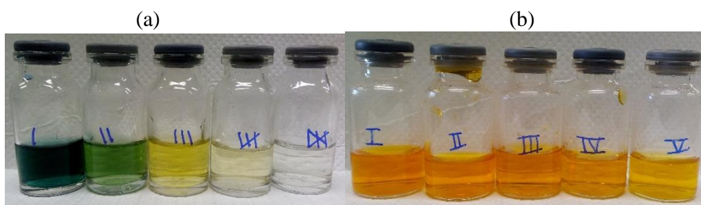
Figura 2- Fotos mostrando a descoloração dos corantes (a) azul de bromotimol e (b) alaranjado de metila em função do tempo de fotólise.
