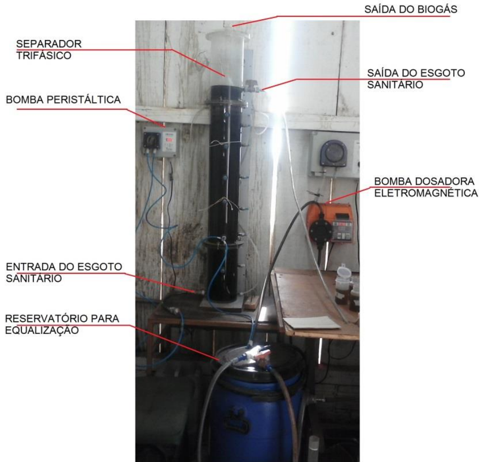
Figura 2: Reator UASB utilizado para o tratamento de esgoto sanitário do campus universitário.
