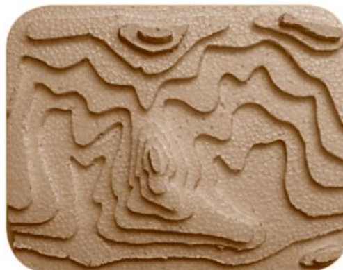
Figura 4 - Estrutura das curvas de nível
