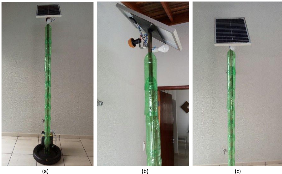
Figura 1: (a) Sistema de iluminação sustentável, (b) Sensor de luz, lâmpada e interruptor e (c) Placa solar.
