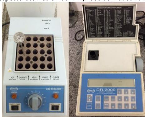
Figura 5: COD Reactor Hach e espectrofotômetro Hach DR/2000 utilizados na análise dos parâmetros NT e PT.
