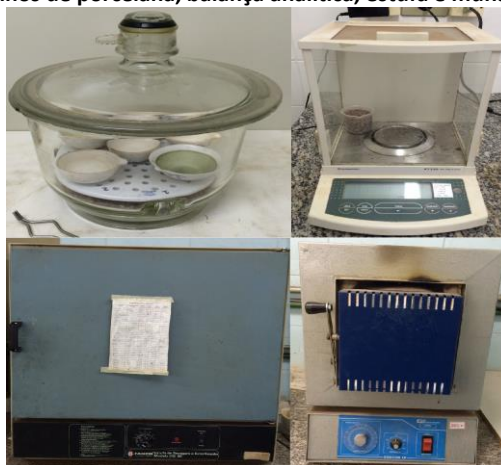
Figura 7: Dessecador, cadinhos de porcelana, balança analítica, estufa e mufla utilizados na análise de ST.
