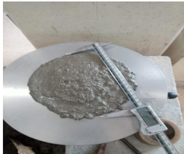
Figure 7 - Ensaio de consistência C2
