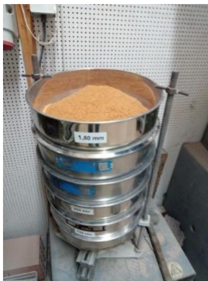
Figura 2 – Verificação da granulometria
