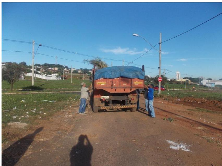
**Figura 5** - Funcionários da PMU colocando a lona para cobrir o resíduos durante o transporte. Uberlândia, 2013
