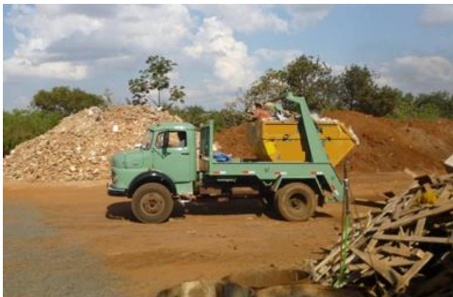
**Figura 7** - Caminhão com caçamba sem dispositivo de cobertura. Uberlândia, 2012
