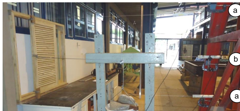
Figura 7: Ponto de fixação (a) e ponto de aplicação da carga (b) do ensaio de resistência à flexão
