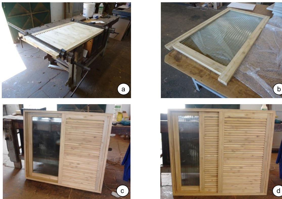
Figura 4: Processo de montagem do componente folha (a), Componente folha com o vidro (b); Ajustes das folhas (c) e Final do processo de montagem (d)
