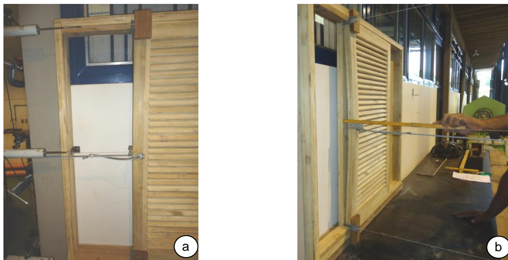
Figura 8: Deslocamento máximo do ensaio de resistência ao esforço horizontal (a) e Deslocamento máximo do ensaio de resistência à flexão (b).
