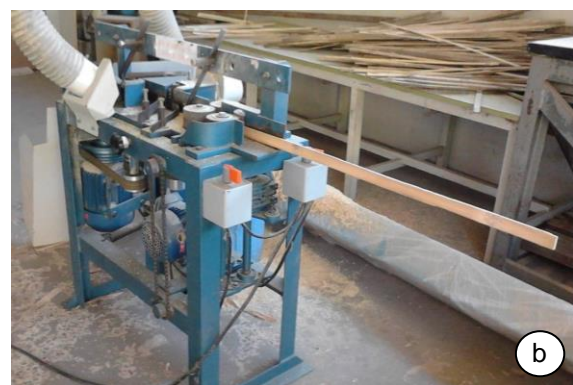
Figura 3: Colmos cortados (a); Laminadora (b); Estufa para controle de umidade (c) e Lâminas pré-usinadas para colagem dos módulos (d), módulos colados (e) e detalhes para encaixe da modulação (f)
