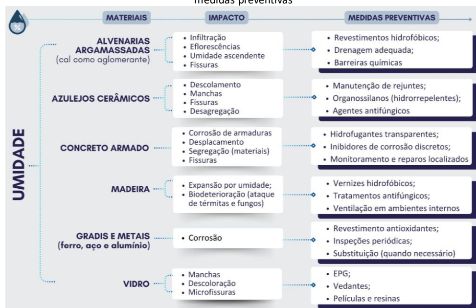
Figura 3 – Fluxograma-resumo dos impactos causados pela ação da umidade em cada material e respectivas medidas preventivas
