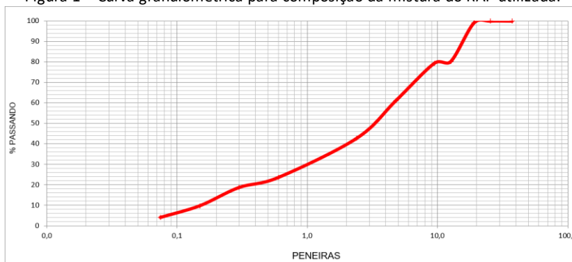
Figura 1 – Curva granulométrica para composição da mistura do RAP utilizada.
