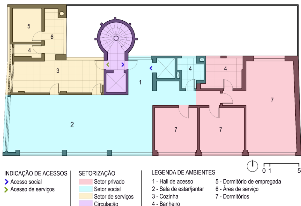
Figura 07 – Planta baixa do pavimento tipo do Edifício Faial.
