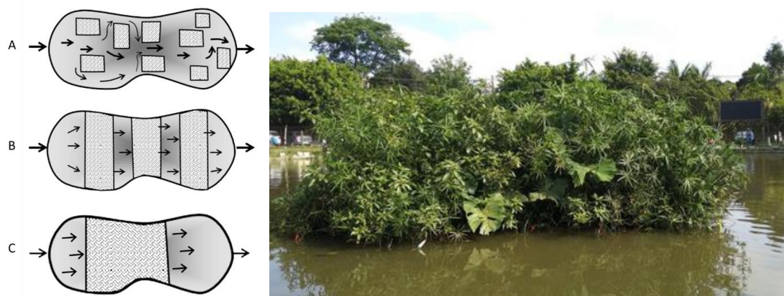
Figura 1 – Opções de desenho do projeto para posicionamento dos FTW e simulação dos fluxos hídricos (esquerda). Foto do projeto implementado (direita).
