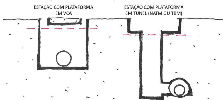
Figura 2 – Croqui de cortes típicos de estações padronizadas rasas (em VCA) e profundas (com plataforma em túnel convencional 3 NATM), com linha tracejada vermelha representado limite entre trecho padroniza profundo e customização com a superfície.
