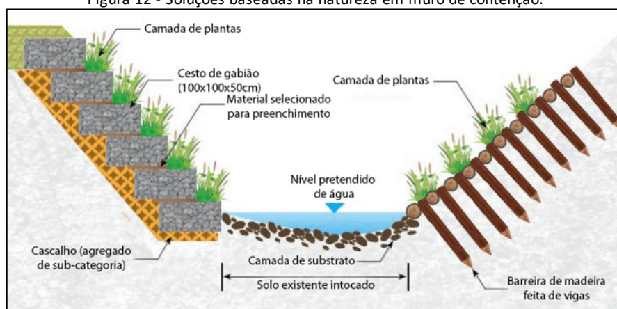
Figura 12 - Soluções baseadas na natureza em muro de contenção.
